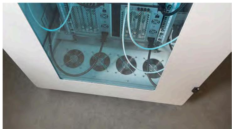
Lüfterblech im Boden des Schrankes mit 4 Lüftern zur Ansaugung von Kaltluft
